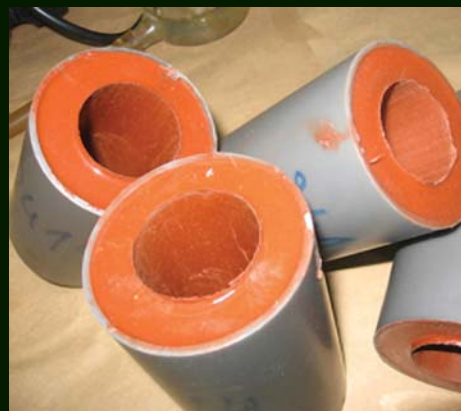
Инхибирани комади композитног ракетног горива
